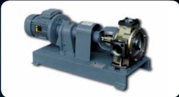
**Pompe ad ingranaggi.** Pompe monoblocco ad ingranaggi paralleli in ghisa, bronzo o acciaio inox sia con motore unificato e giunto elastico che con motore speciale dotato di albero prolungato. Pompe ad ingranaggi interni cicloidali (tipo Viking) per liquidi a bassa, media ed alta viscosità, con o senza motoriduttore o motovariatore e disponibili in diverse combinazioni di materiali (ghisa, bronzo o acciaio inox).
