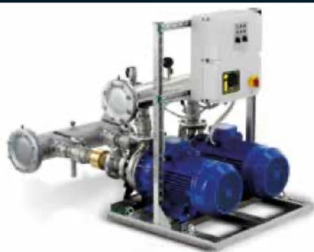
**Gruppi di pressurizzazione con 2 pompe centrifughe monoblocco orizzontali** derivate da EN733 con idraulica in acciaio inox, ideati per impianti civili ed industriali. Automazioni a pressostati oppure a pressione costante con inverter e trasduttore di pressione.
